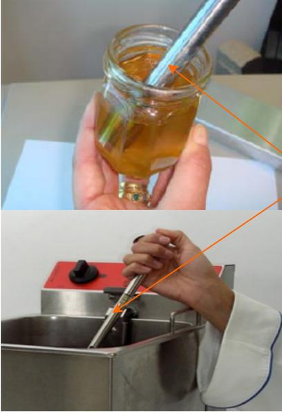
**3** يغمر المسبار داخل الزيت المراد اختبارها ، بطريقة يكون فيها مثبت ومائل بزاوية 45 درجة ، بحيث تكون الفجوات الهوائية الأربعة مغمورة كلياً .
